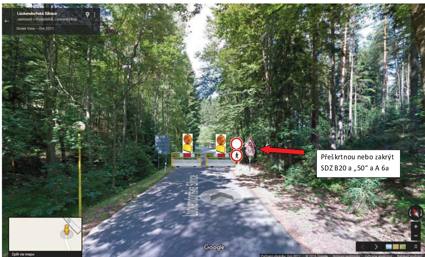
Pohled na hraniční přechod Petrovice ve směru od SRN – návrh dopravního značení B1 „zákaz vjezdu všem vozidlům“ a betonového svodidla a B 30 Zákaz vstupu chodců a Z2
