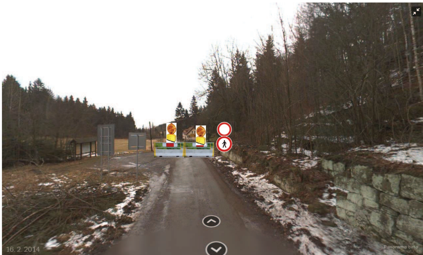
Pohled na hraniční přechod Kropáč ve směru od České republiky – návrh dopravního značení B1 „zákaz vjezdu všem vozidlům“ a betonového svodidla a B 30 Zákaz vstupu chodců a Z2.
