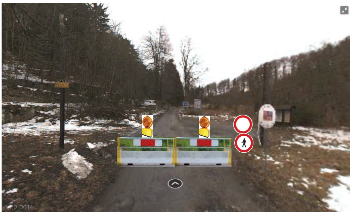
Pohled na hraniční přechod Kropáč ve směru od SRN – návrh dopravního značení B1 „zákaz vjezdu všem vozidlům“ a betonového svodidla a B 30 Zákaz vstupu chodců a Z2.
