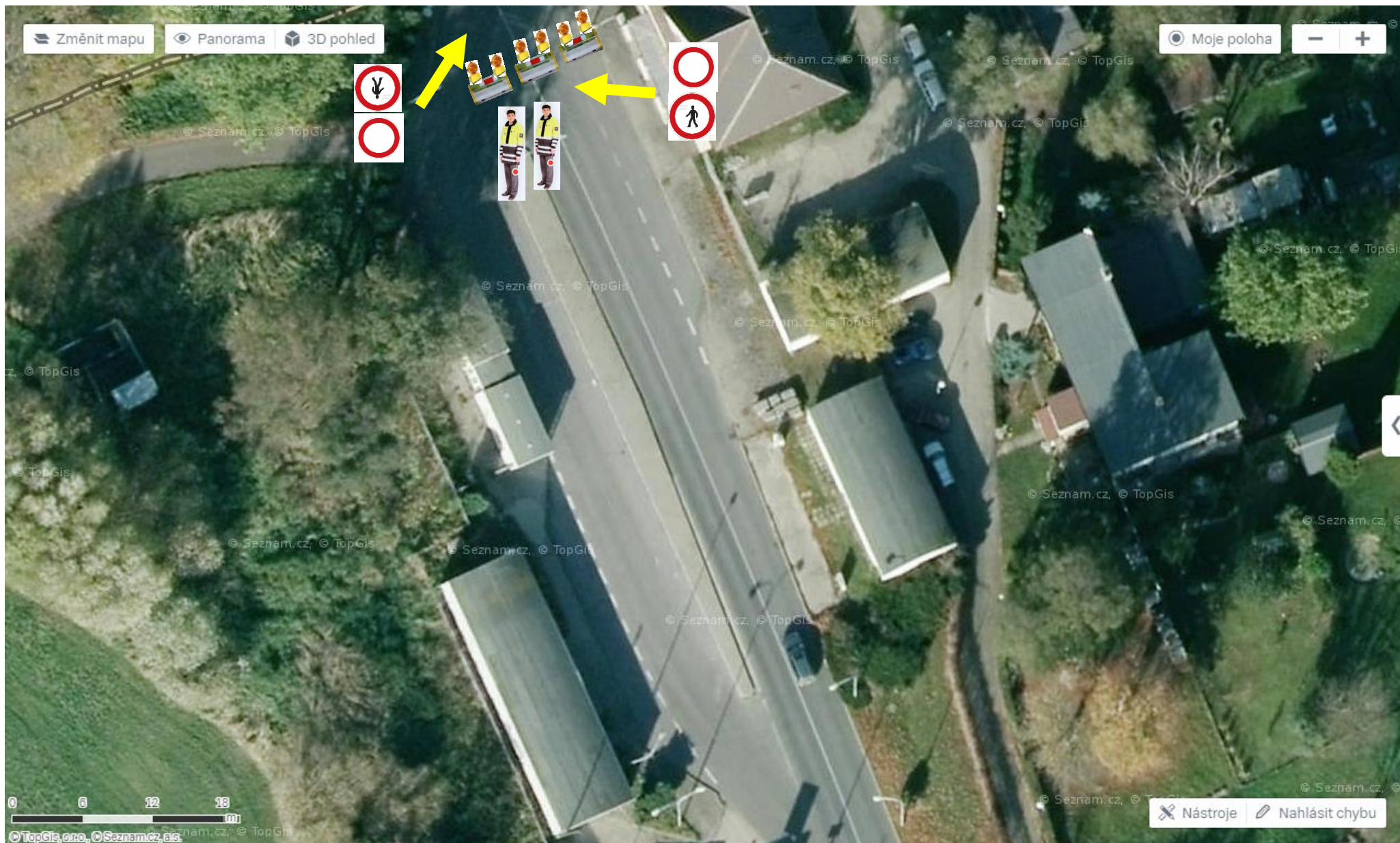
Návrh přechodného dopravního značení č. B1, č. B30, betonových svodidel včetně výstražných světel S7 typ 1 na silnici I. třídy č. 35L u HP.
